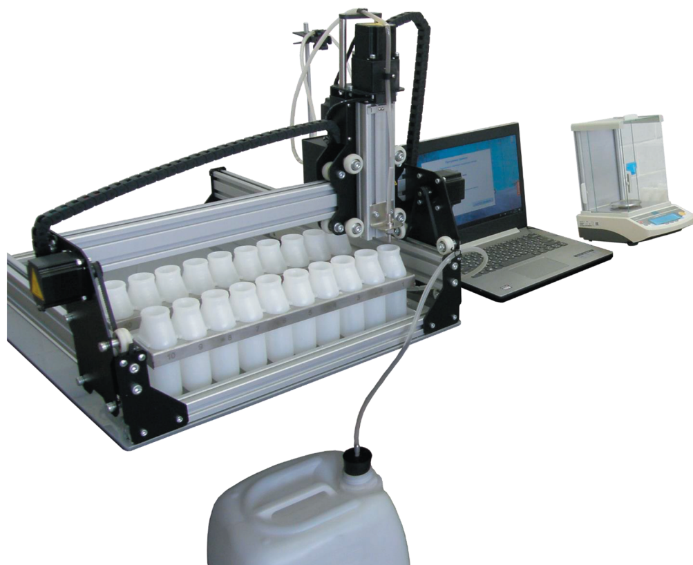
Рис. 1. Дозатор ДЖ-10М с кассетами КБМ, компьютером с программой управления комплексом и весами. Внизу – емкость для забора экстрагента (раствор 1 М КСl).
