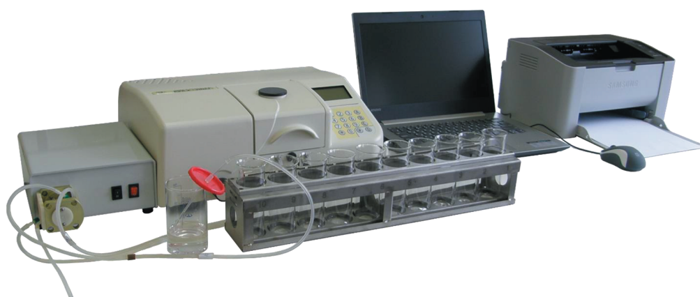
Рис. 2. Фотометрический комплекс, включающий фотометр КФК 3-1-01 с не прижимным перистальтическим насосом, компьютером с программой для обработки аналитических результатов, печатающим устройством и кассетой КТМ.
