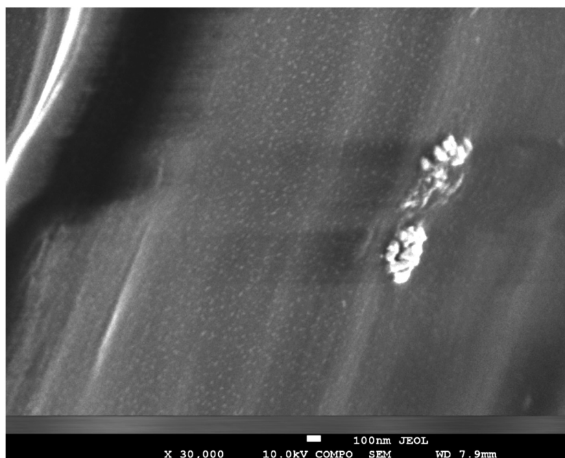
Рис. 2. Электронная микрофотография наночастиц серебра на поверхности волокон шелка в составе альгинатно-тканевого покрытия в режиме детектирования отраженных электронов после выполнения десятикратной циклической заморозки.
