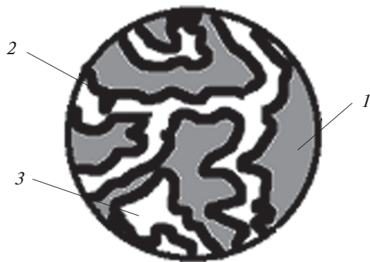
Рис. 3. Структура пористого электрода: 1 – электропроводная основа; 2 – активная масса; 3 – электролит.
