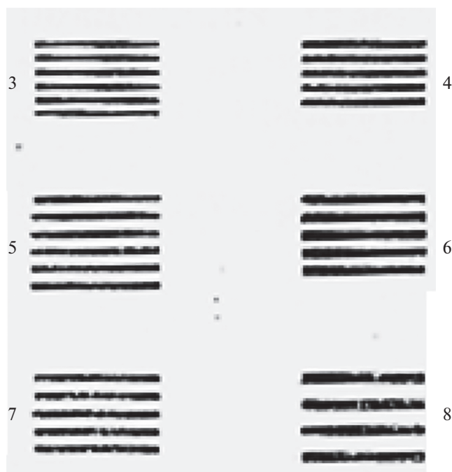
Рис. 2. Мира с параллельной структурой (тест Фуко) [12].
