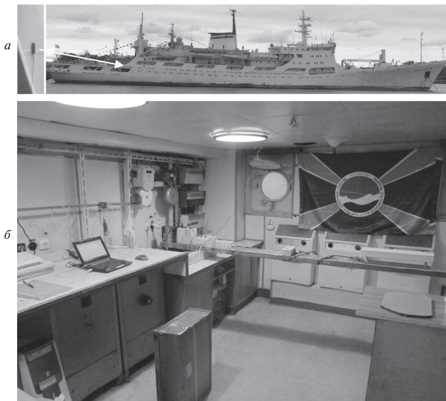
Рис. 1. Магнитометрическая лаборатория на ОИС “Адмирал Владимирский”. (а) – положение лаборатории и датчика GPS на судне; (б) – вид лаборатории с двумя компонентными магнитометрами и системой регистрации данных.
