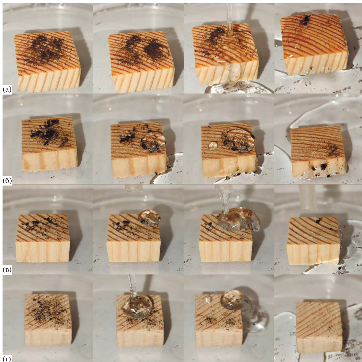
Рис. 5. Демонстрация эффекта самоочистки поверхности древесины, пропитанной: (а) А4; (б) D2; (в) G3; (г) G4; в результате воздействия струи воды и капли крупного размера.
