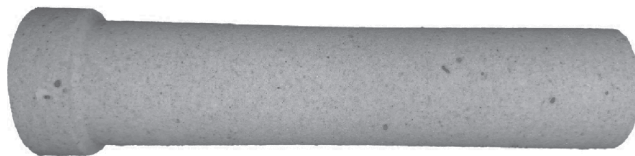
Рис. 1. Трубчатая пористая керамическая подложка на основе \alpha - \text{Al}_2\text{O}_3 .
