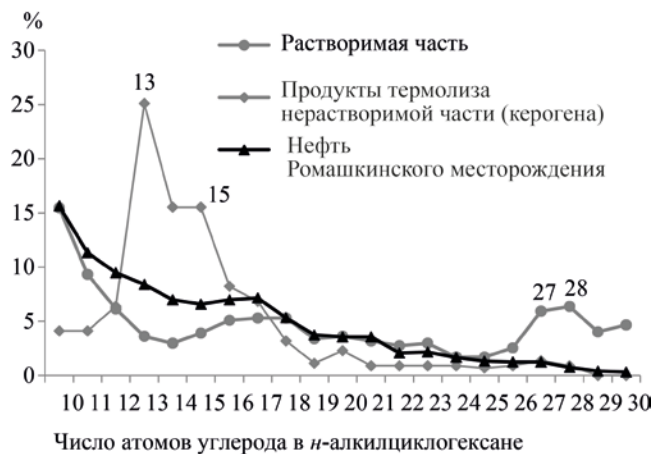
Рис. 3. Распределение n -алкилциклогексанов состава C_{10} – C_{30} в растворимой части, продуктах термолитиза нерастворимой части биомассы бактерий Halomonas titanicae и нефти м-ия Ромашкинское, скв. 26426.
