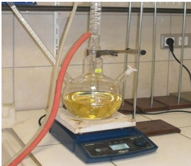
Рис. 3. Реакция межмолекулярной переэтерификации.
