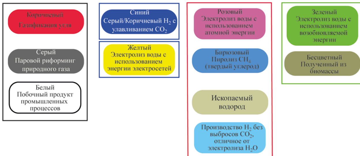
Рис. 1. Градация методов получения водорода на основе их предполагаемого воздействия на климатические процессы.
