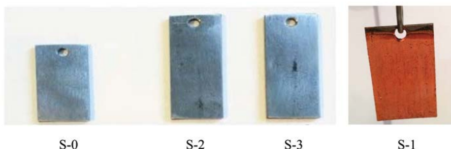
Рис. 1. Образцы углеродистой стали, выдержанные в течение 200 ч в среде мазут-катализатор-воздух: S-0 – исходная пластина углеродистой стали; S-1, S-2 и S-3 – образцы стали, выдержанные в мазуте в присутствии катализаторов К-1, К-2 и К-3, соответственно; 90°C; V_r/V_{ж} = 0.4 ; [H_2S]_0 = 128 ppm; [C_2H_5SH]_0 = 72 ppm; [kat] = 300 ppm.
