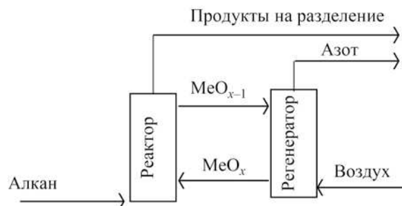
Рис. 13. Принципиальная технологическая схема циклического дегидрирования [147].
