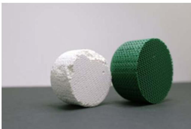
**Рис. 6.** Блочный катализатор (слева) и катализатор, приготовленный с применением аналогичного пластикового темплата (справа).
