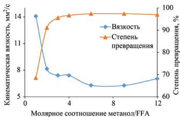
Рис. 4. Зависимость степени превращения FFA в биодизель типа FAME и кинематической вязкости от концентрации метанола [Условия реакции: T = 60^\circ\text{C} ; концентрация HCl 5.0 мас. % FFA; время этерификации 120 мин; смеси реагентов непрерывно перемешивают при нагревании с обратным холодильником].
