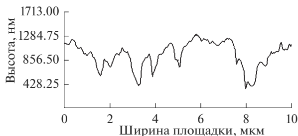
Рис. 2. Профилограмма поверхности кварцевых стержней.
