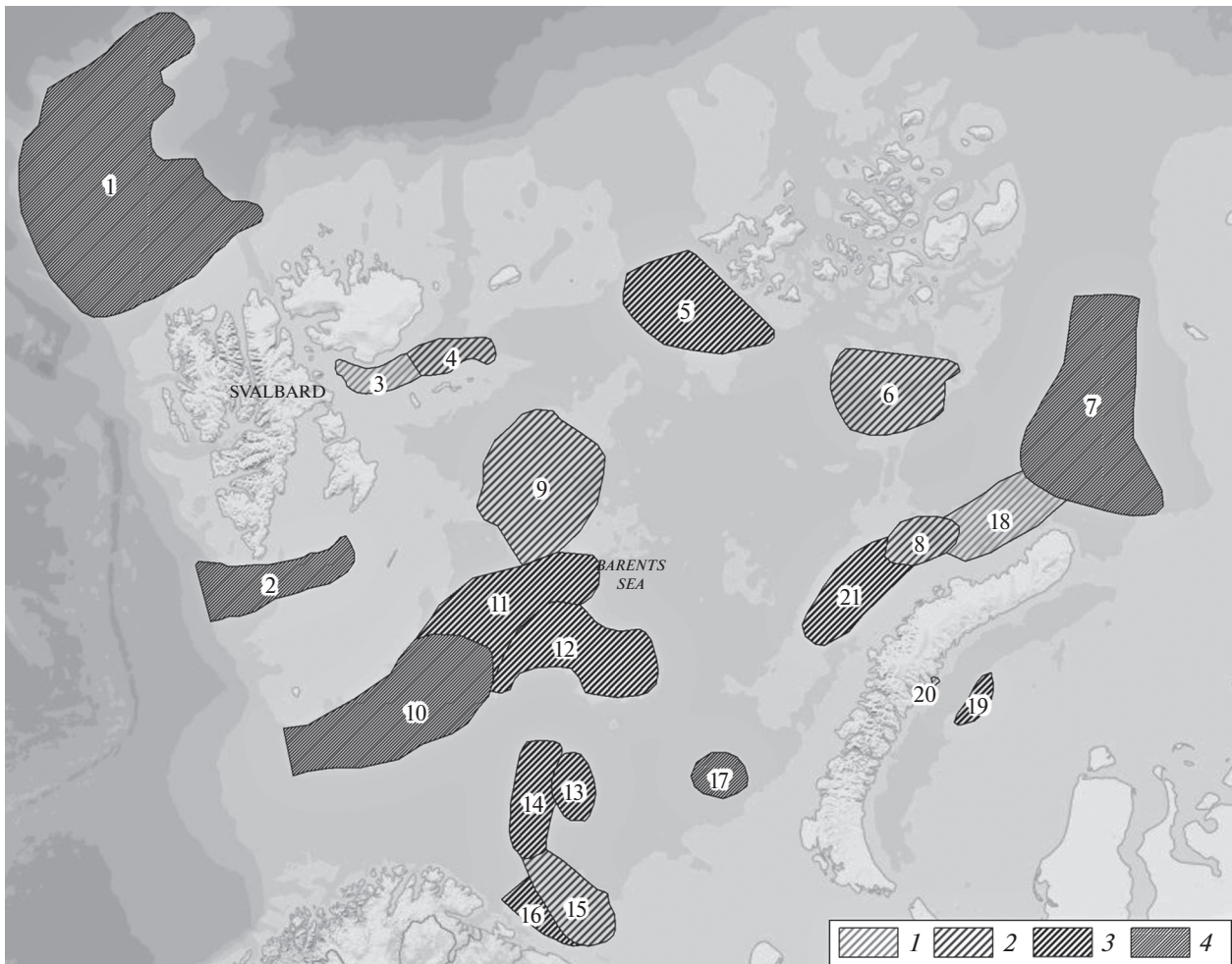
Рис. 1. Районы обнаружения форм айсберговой экзарации в Баренцево-Карском регионе. Борозды на глубинах: 1 – менее 100 м, 2 – 100–200 м, 3 – 200–300 м, 4 – более 300 м. На схеме обозначены цифрами (источник): 1 – плато Ермак [57], 2 – Стур-фьорд [7], 3 – южный шельф Северо-Восточной Земли [54], 4 – шельф Земли Короля Карла [7], 5 – западный шельф ЗФИ [7], 6 – Альбановский участок (Северо-Восточное плато) [19], 7 – трог Св. Анны [53], 8 – Варнекский участок [19], 9 – банка Персея [40, 55], 10 – Медвежинский желоб [40], 11 – желоб Персея [40], 12 – Центральная возвышенность [40], 13 – свод Федынского [20], 14 – банки Тиддли и Тор-Айверсен [40], 15 – Мурманская банка [19, 40], 16 – Кольский желоб [32], 17 – Штокмановский участок [18, 19], 18 – плато Литке [18], 19 – склон Новоземельского желоба [34], 20 – заливы Степового, Цивольки, Ога, Седова, Благополучия [33], 21 – Адмиралтейский вал [18].
