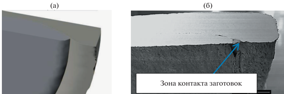
Рис. 10. Сравнение результатов моделирования и осадки пакета из двух заготовок из сплава БрХ08: (а) – моделирование (92%); (б) – эксперимент.
