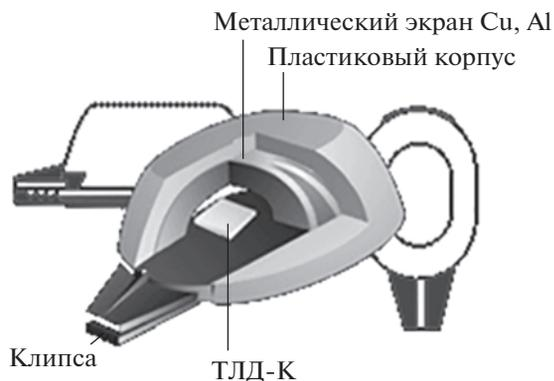
Рис. 2. Термолуминесцентный дозиметр с детектором ТЛД-К.
