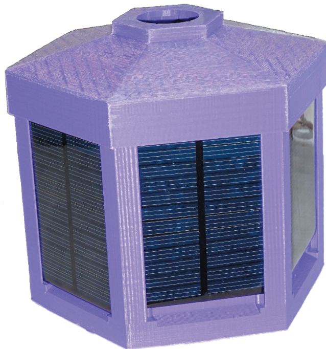
Рис. 2. Прототип корпуса модуля питания и связи.
