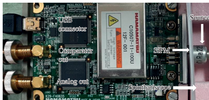
Рис. 1. Фотография использованного модуля MPPC с источником излучений.
