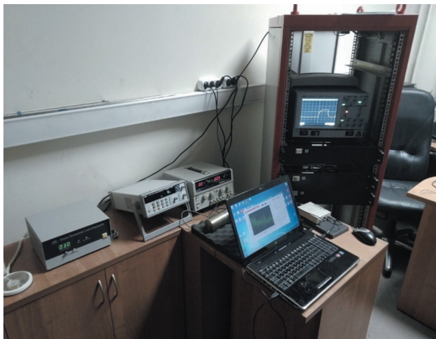
Рис. 9. Экспериментальный тестовый стенд на основе модуля счета фотонов и детектора оптического излучения.
