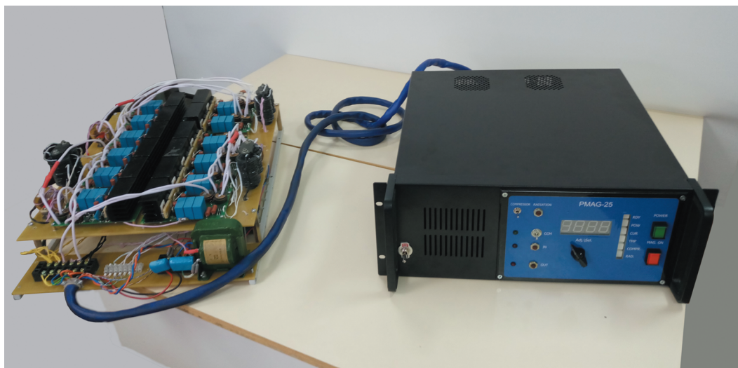
Рис. 2. Инверторный (справа) и модуляторный (слева) блоки системы генерации мощных СВЧ-импульсов.
