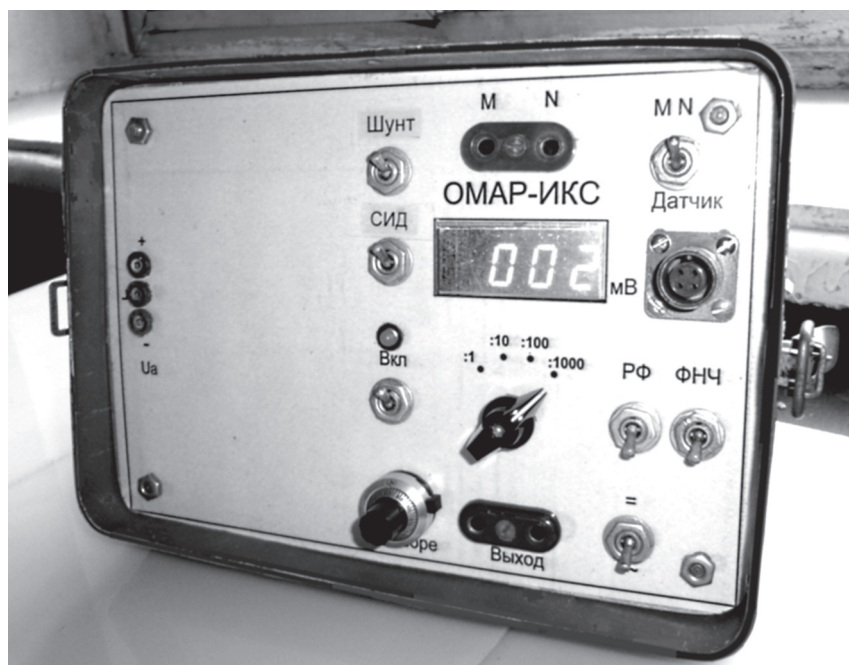
Рис. 1. Внешний вид приемника ОМАР-ИКС в режиме контроля уровня шумов.
