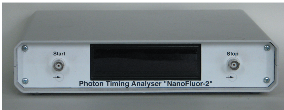
Рис. 5. Компактный электронный блок времякоррелированного счета фотонов одноквантового спектрометра ФЛУОР в корпусе Unicas SL-3.
