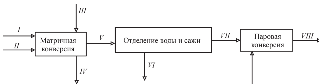
Рис. 1. Схема совмещенного процесса некаталитической матричной конверсии углеводородных газов и каталитической паровой конверсии получаемого синтез-газа.
