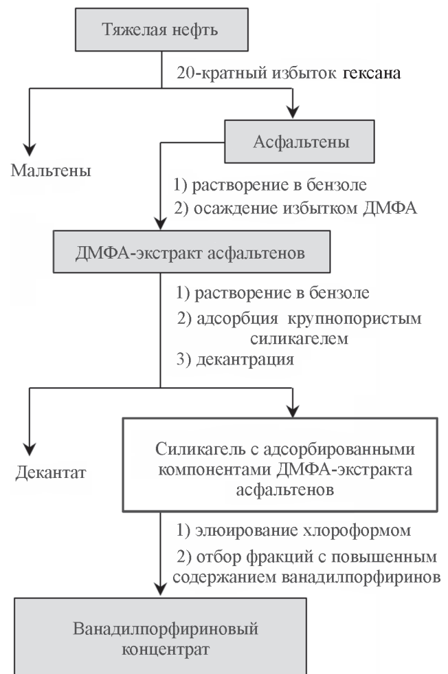
Рис. 7. Схема концентрирования нефтяных ванадилпорфиринов с применением адсорбционно-экстрографического метода.
