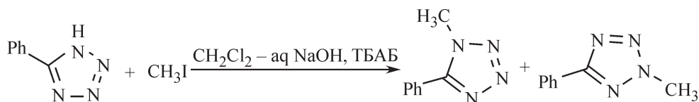
Рис. 5. Схема алкилирования 5-фенилтетразола иодистым метилом в двухфазной реакционной системе хлористый метиле–NaOH(aq.).
