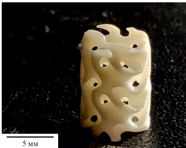
Рис. 1. Конструкция на основе гидрогелей полиэтиленгликоль-метакрилат/полиэтиленгликоль-диакрилат, наполненных \alpha -Ca 3 (PO 4 ) 2 , со структурой гироида, полученная путем стереолитографической 3D-печати [37].*
