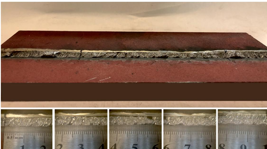
Рис. 3. Внешний вид излома сварного шва пластины с покрытием на основе разработанной двухкомпонентной межоперационной эпоксидной грунтовки, рецептура которой представлена в табл. 3.
