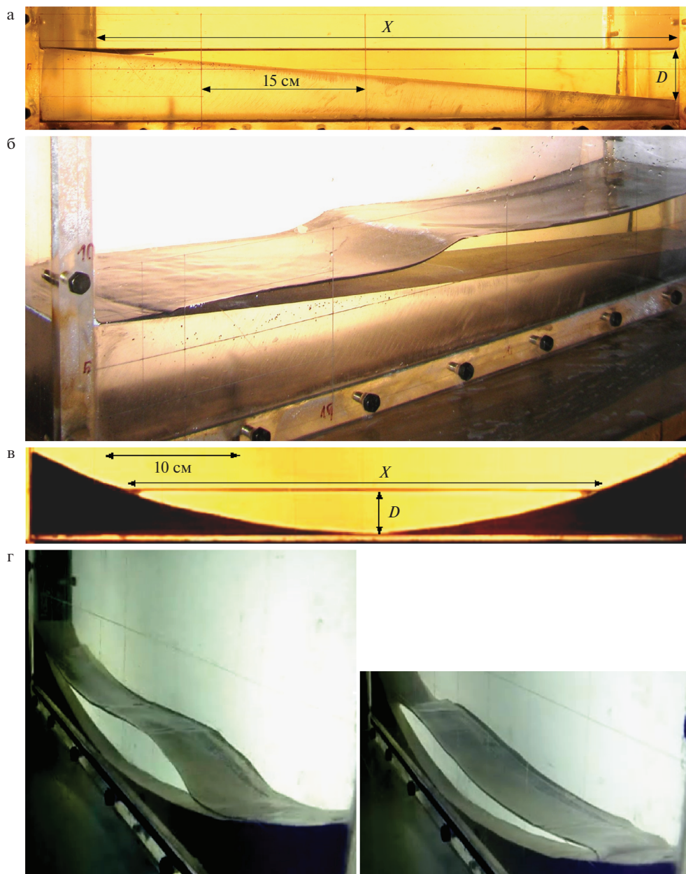
Рис. 3. Конфигурация I. а: Сосуд с плоским наклонным дном, фронтальная камера, и б: четвертая мода двумерных стоячих волн, угловая камера. Конфигурация II. в: Сосуд с вогнутым параболическим дном, фронтальная камера, и г: третья мода двумерных стоячих волн, угловая камера, показаны волны максимального развития.
