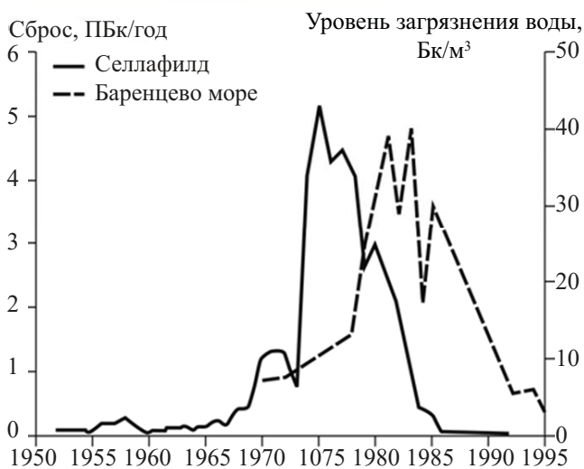
Рис. 11. Зависимость уровня загрязнений морской воды Баренцева моря ( \text{Бк}/\text{м}^3 ) от объемов сбросов радионуклидов – продуктов деления от радиохимического производства Селлафилд (Великобритания, \text{ПБк}/\text{год} ) за счет их переноса течением Гольфстримом (1950–1995 гг.)
