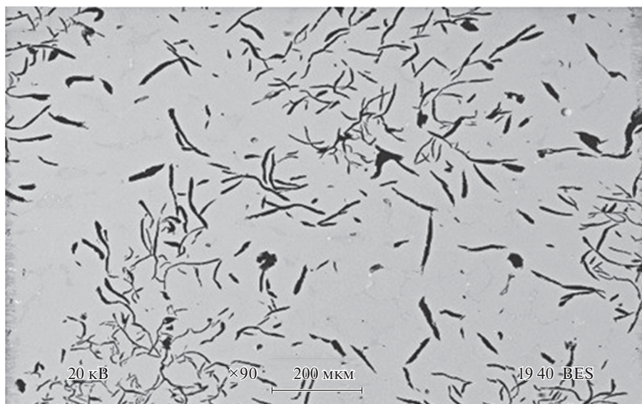
Рис. 1. Фото участка микрошлифа исходного образца чугуна “нирезист”.
