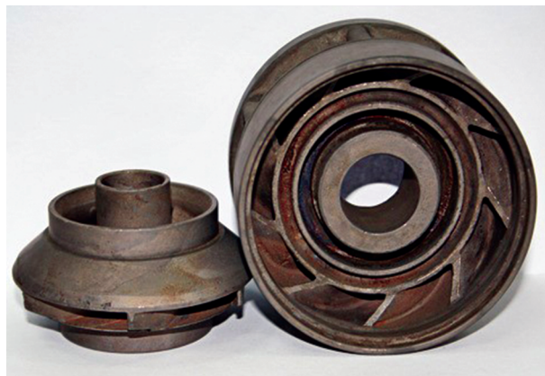
Рис. 7. Детали нефтяного насоса, борированные при 850°C в течение 2 часов.
