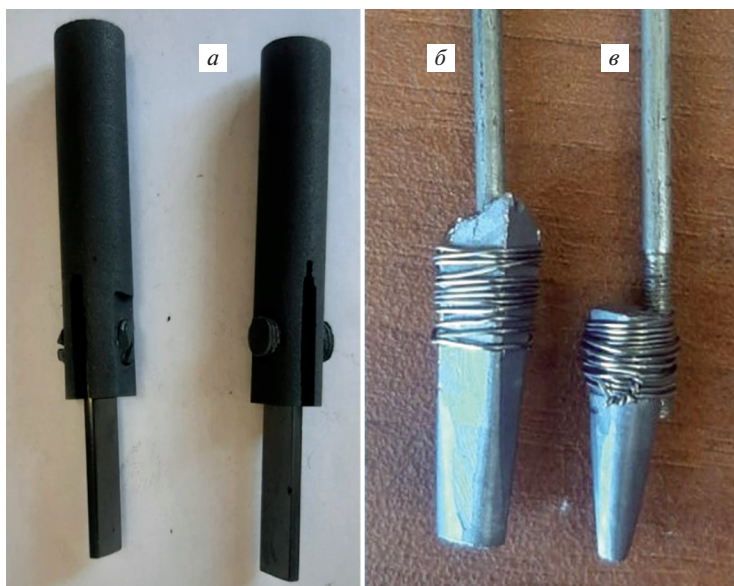
Рис. 2. Электроды для исследования: а – стеклоуглеродный рабочий электрод в графитовой втулке; б – кремниевый противоэлектрод; в – кремниевый квазиэлектрод сравнения.
