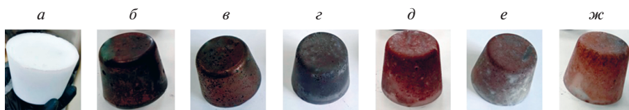
Рис. 3. Внешний вид расплава после коррозионных испытаний. a – Исходный образец; образцы, выдержанные в расплаве FLiNaK при концентрации O 2- , ppm: б – 0, в – 700, г – 1400, д – 2800, ж – 5600, з – 11200.
