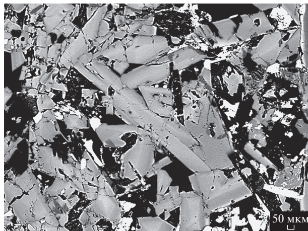
Рис. 6. Матрица минетт: призматические кристаллы санидина (светлые зоны кристаллов обогащены барием – ан. 17). В промежутках между кристаллами санидина призмы арфведсонита (светлые) и ксеноморфный кальцит (черный). Изображение в отраженных электронах.
