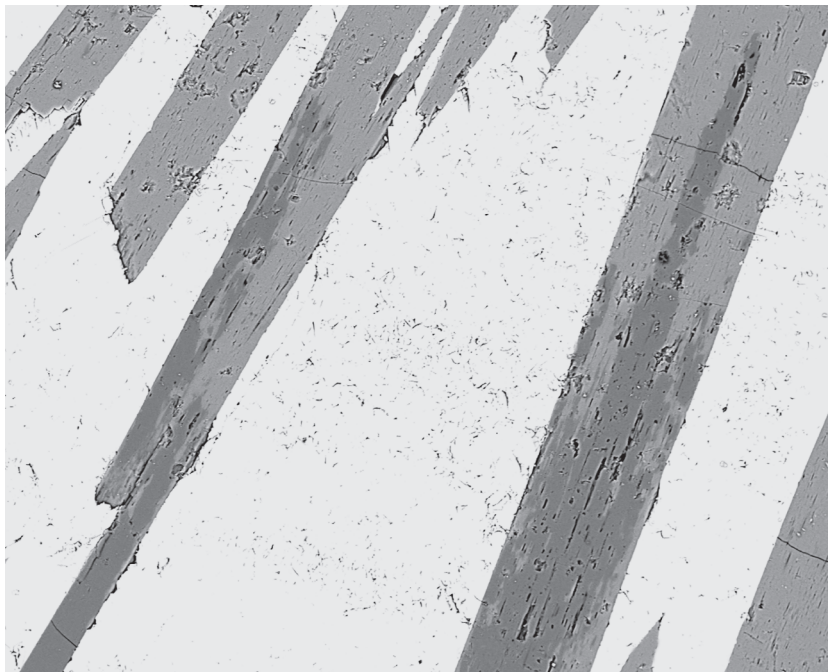
Рис. 7. Край открытого сферолита мезолита. Начальная стадия замещения игл мезолита (серый, ан. 15) – натролитом (темно-серый, ан. 17) в центре кристаллов мезолита. Матрица – кальцит. В отраженных электронах.
