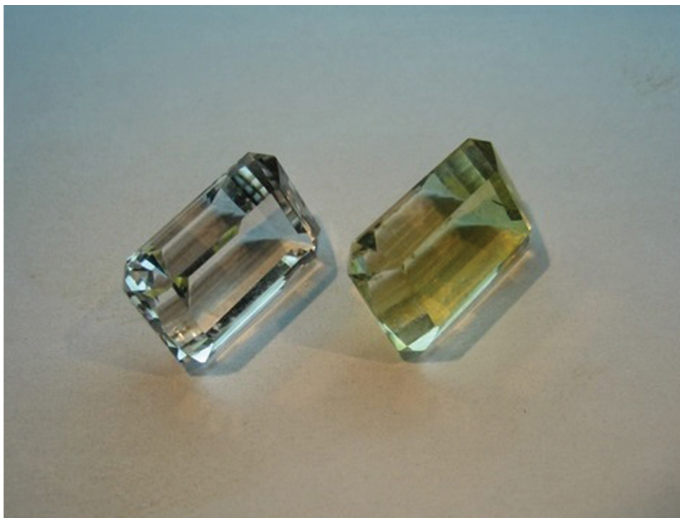
Рис. 1. Слева исходный ограненный горный хрусталь, справа имплантированный ионами ванадия с дозой 1.5 \times 10^{17} ион/см 2 и отожженный при температуре 383 °С, 30 мин.
