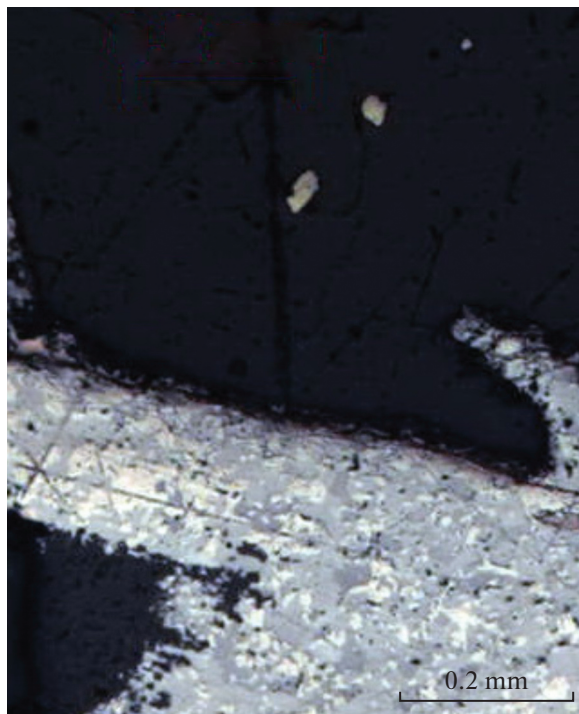
Рис. 1. Жила 5 Электрическая. Висмутин II и самородный висмут – продукты распада икунолита в жильном кварце. Изображение в отраженных электронах.
