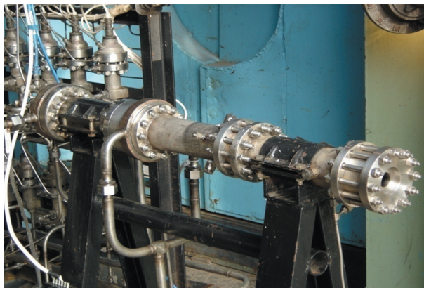
Рис. 1. Экспериментальный водородно-кислородный парогенератор тепловой мощностью до 25 разработки ОИВТ РАН на стенде АО «КБХА» (Россия).
