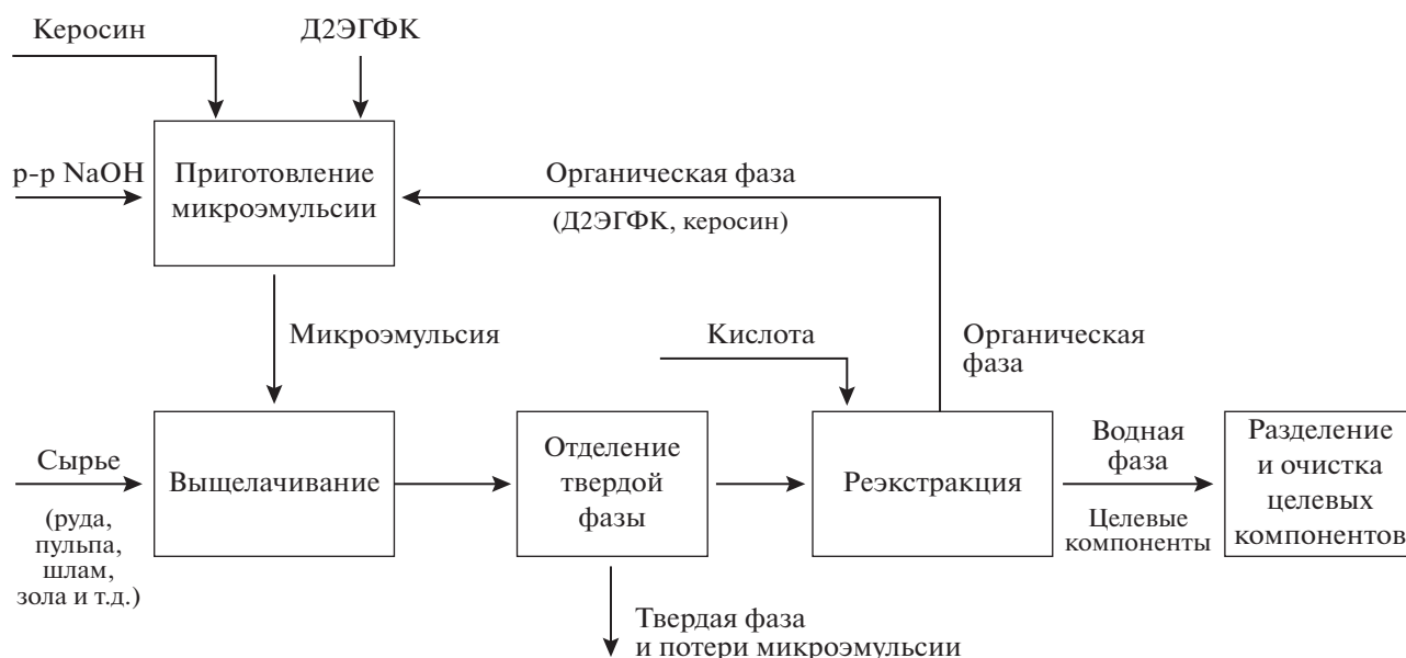
Рис. 4. Обобщенная схема микроэмульсионного выщелачивания [74, 79].
