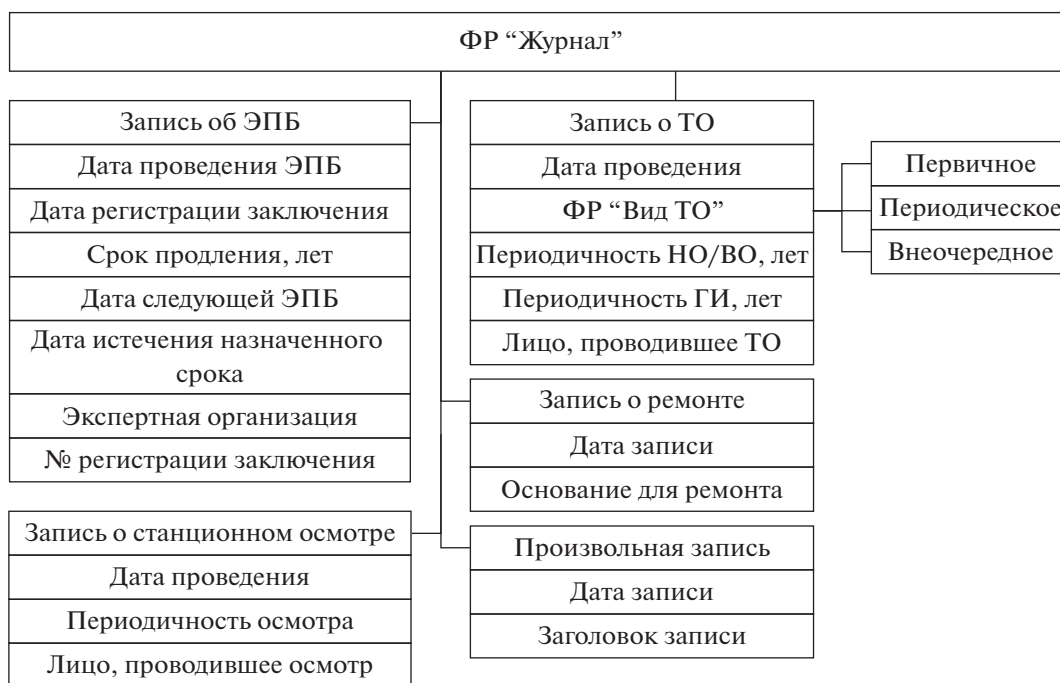
Рис. 8. Фрейм-прототип “Журнал”: ЭПБ – экспертиза промышленной безопасности; ГИ – гидравлические испытания; НО – наружный осмотр; ВО – внутренний осмотр.
