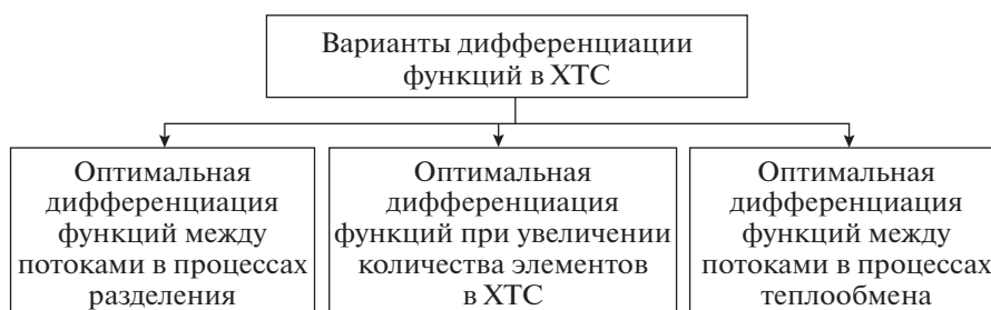
Рис. 1. Основные варианты дифференциации функций в ХТС.
