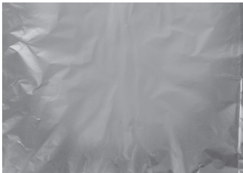
Рис. 13. Оптическая фотография нетканого материала, полученного при электроформовании раствора СПАК(I)–II при концентрации 12 мас. %.
