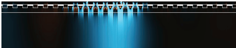
Фиг. 10. Главная вертикальная компонента тензора напряжений Коши, \sigma_{zz} . Глубина ползуна 2 мм. Скорость поезда 15 км/ч.
