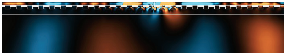
Фиг. 11. Сдвиговая компонента тензора напряжений Коши, \sigma_{xz} . Глубина ползуна 2 мм. Скорость поезда 120 км/ч.
