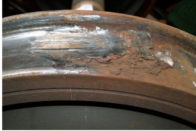
Фиг. 3. Колесная пара с ползуном.
