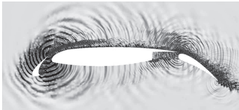
Фиг. 19. Полученное в вычислительном эксперименте мгновенное поле давления, формирующееся при турбулентном обтекании крыла с механизацией.
