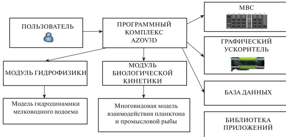
Фиг. 10. Схема программного комплекса.
