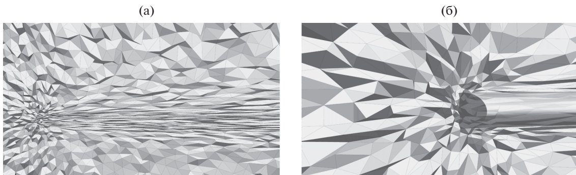
Фиг. 30. (а) – Призматическая сетка, охватывающая поверхность ротора внутри и снаружи расчетной области, (б) – адаптивная сетка.
