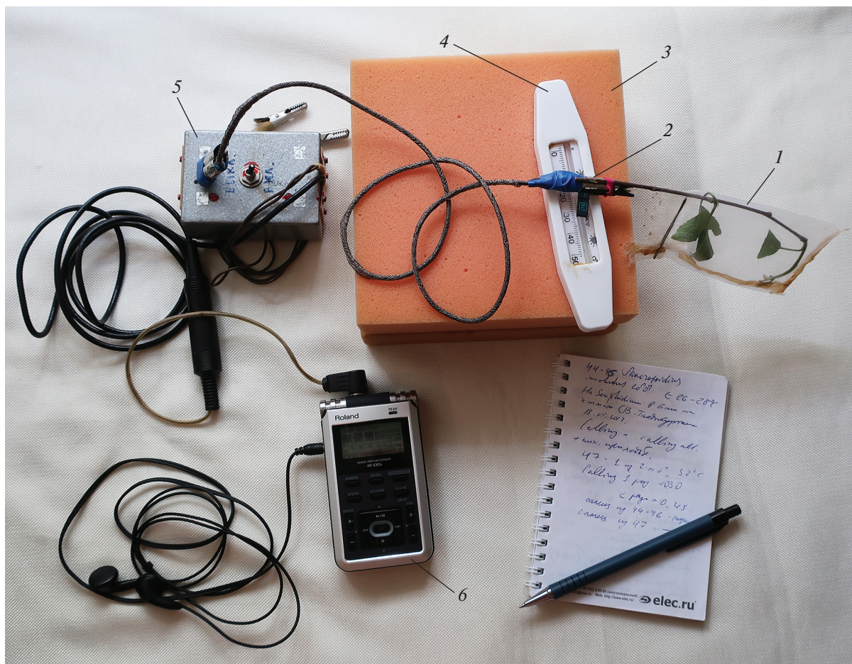
Рис. 1. Портативная установка для записи вибрационных сигналов мелких насекомых, используемая автором обзора. 1 – Побег растения с надетым на него нейлоновым садком; растение закреплено на корпусе адаптера резиновым кольцом; 2 – монофонический адаптер (головка звукоснимателя) от проигрывателя для виниловых дисков; 3 – поролоновая подложка для изоляции от вибрационных помех; 4 – термометр; 5 – согласующий усилитель; 6 – флэш-рекордер.
