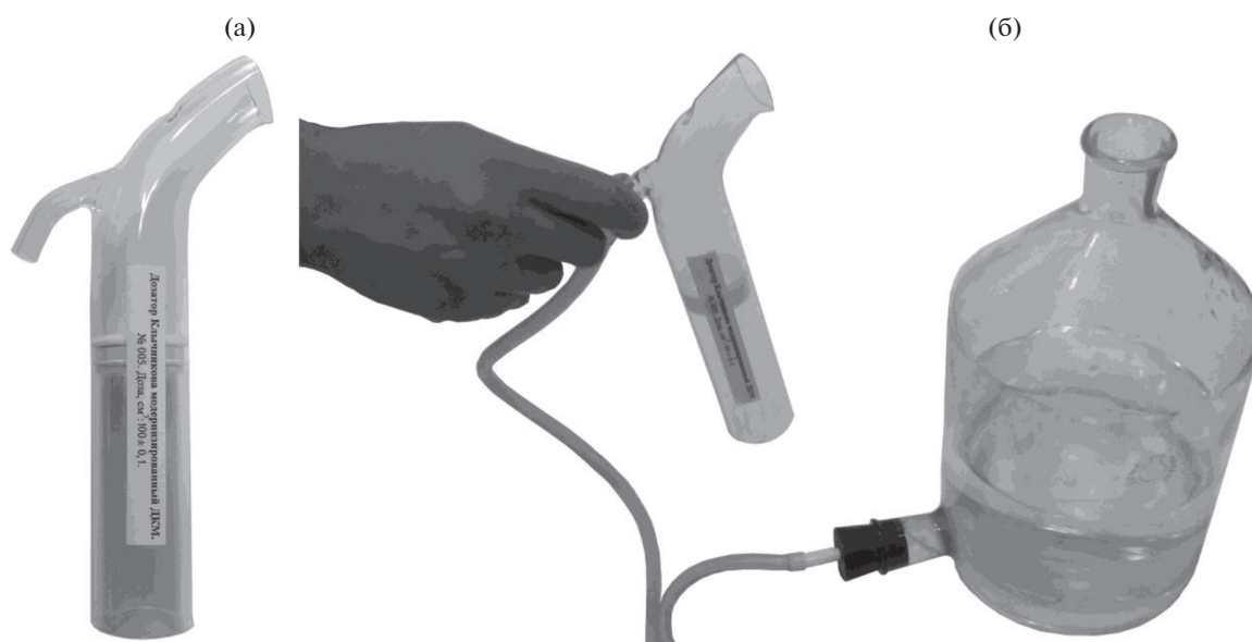
Рис. 3. Однопозиционный ручной дозатор Клычникова: (а) – отдельный дозатор, (б) – в сборе.
