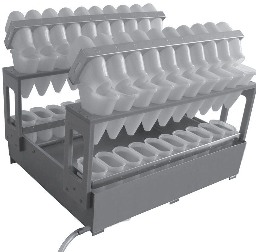
Рис. 7. Фильтровальная установка БФМ-2 для фильтрации почвенной суспензии из кассет КБМ в кассеты КММ.
