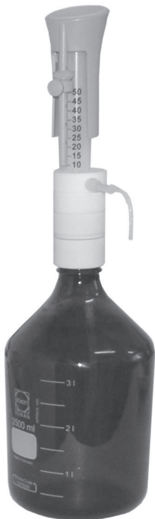
Рис. 9. Дозатор для дозирования раствора хлорида бария в отобранные дозы почвенной вытяжки.
