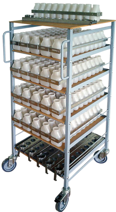
Рис. 6. Тележка ТТП для транспортировки кассет КБМ к аналитическим позициям: на нижнем ярусе тележки находятся крышки КК для герметизации кассет КБМ. На крышке тележки производится операция герметизации кассет КБМ.
